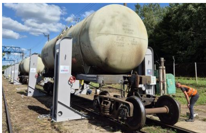
Рис. 1.20. Пункт перестановки (заміни візків вантажних вагонів) на станції Мостиська-2 Львівської залізниці.
