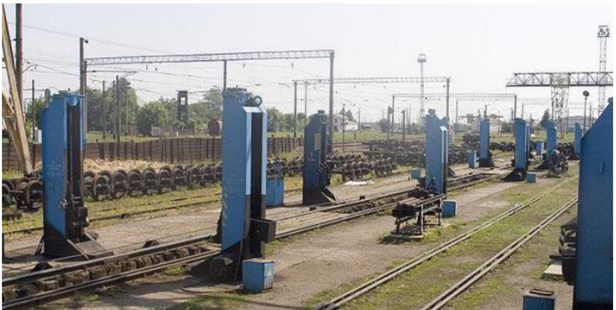
Рис. 1.18. Пункт перестановки пасажирських вагонів станції Чоп, обладнаний вагонними домкратами та суміщеними коліями.
