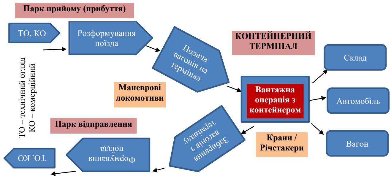
Рис. 3.3. Технологічна лінія з обробки контейнерних поїздів та груп вагонів
