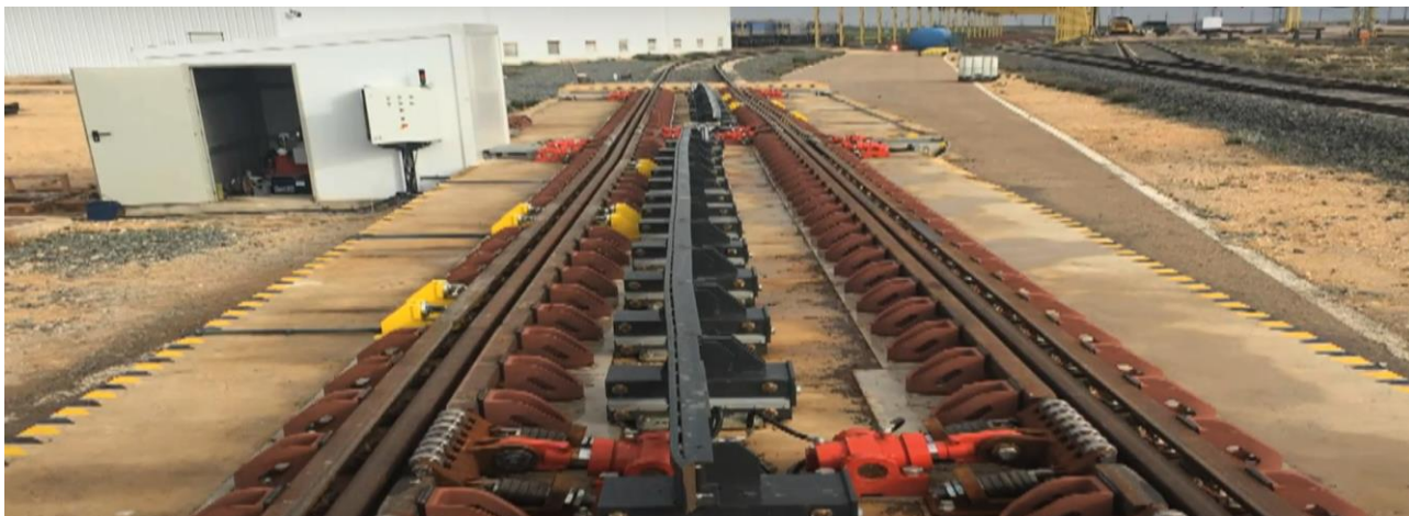
Рис. 1.24. Загальний вид колієперевідного пристрою системи Adif.
